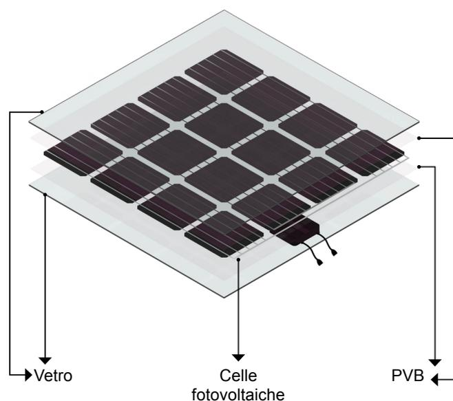
Sunlight, grazie alla sua versatilità, offre una soluzione innovativa per la produzione di energia sostenibile integrando nel tetto vetri fotovoltaici stratificati. Le celle fotovoltaiche di Sunlight sono strategicamente disposte a griglia, sfruttando al massimo la superficie disponibile. In una configurazione di dimensioni 6x4,5 metri, Sunlight è in grado di generare una potenza notevole di 1,4 kW.
