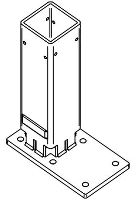
STANDARD - Pied de colonne avec descente pluviale
