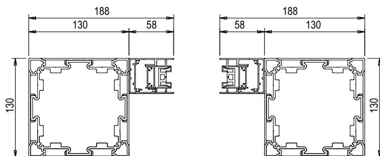
Fixation de la colonne avec sortie d'eau - colonne
