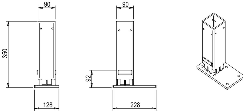
STANDARD - Pied de colonne avec descente pluviale
