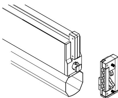
WIND BLOCK: Système de blocage automatique de la barre du charge applicable au Screeny 110 et 130 avec un guide GPZ C, I et GPZ GPZ Unica. Sous l'action du vent, la barre de charge est verrouillée en position basse et la toile, store ouvert, reste constamment tendue.
