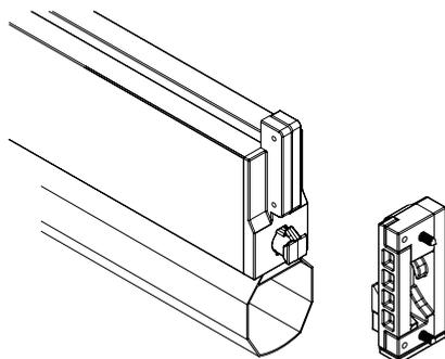
WIND BLOCK: Sistema di blocco automatico del terminale applicabile alle Vertika 110 e 130. Sotto l'azione del vento il terminale viene bloccato in posizione bassa se il tessuto, a tenda aperta, è costantemente tensionato.
