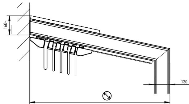
**Larghezza interasse guide/Guides interaxis width/Breite des Achsabstandes der Führungsschienen/Largeur entraxe coulisser/Linea guía intereje**
