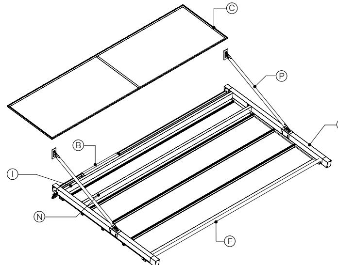
Struttura a pensilina in alluminio con tenda richiudibile ad impacchettamento formata da un telo fissato ad un sistema di traversi e guide che ne permettono lo scorrimento orizzontale. La struttura poggia su due staffe laterali che fungono da spinta e stabilizzano la struttura stessa. Resistenza al vento garantita fino alla classe 6 secondo la EN 13561.
