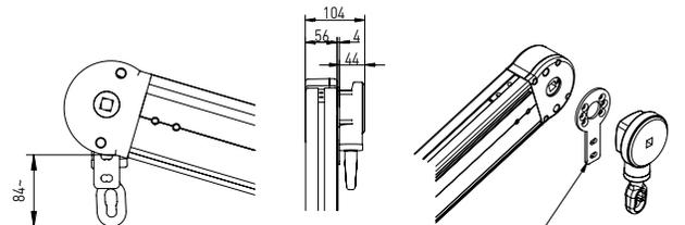
**Supporto per arganello/Reduction winch support/Getriebekonsole/Support pour treuil/Soporte maquina reductora**
