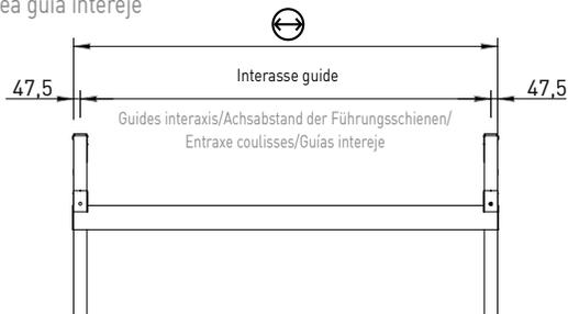
**Dimensioni profili/Profiles dimensions/Profilabmessungen/Mesures profils/Dimensiones perfiles**
