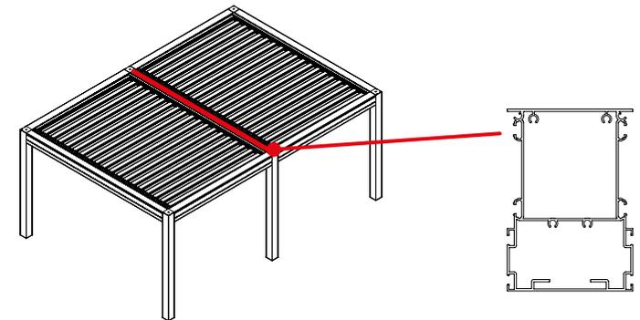
ACHTUNG: DIE ABDECKUNGEN WERDEN IMMER 5 CM LÄNGER GELIEFERT, SO DAS SIE AUF DER BAUSTELLE OPTIMAL ANGEPAST WERDEN KÖNNEN.
