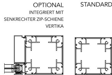
TRAVERSENPROFIL ZWISCHEN 2 MODULEN
