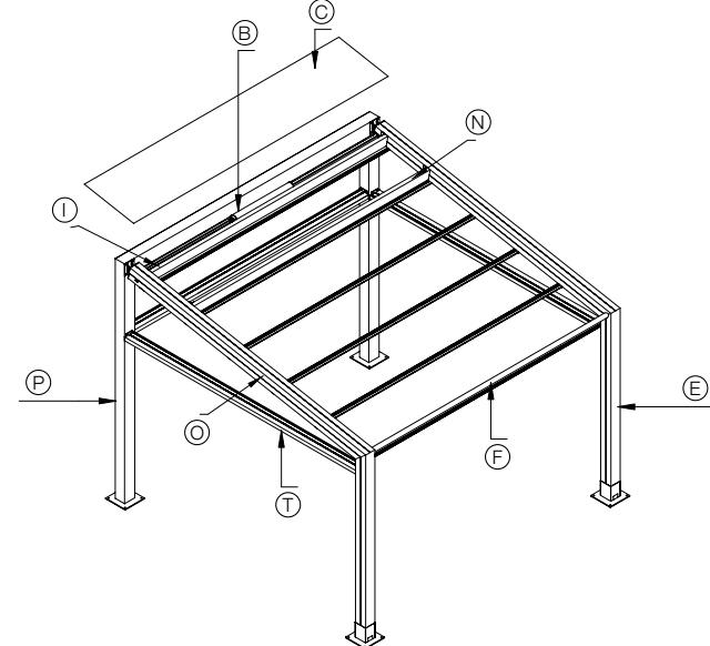
Struttura ombreggiante autoportante in alluminio con tenda richiudibile ad impacchettamento, formata da un telo (teso quando aperta) fissato ad un sistema di traversi, carrelli e guide che ne permettono lo scorrimento orizzontale. Resistenza al vento garantita fino alla classe 6 secondo la UNI EN PR 13561. Su richiesta è possibile installare il sistema antigoccia per la protezione dalla pioggia. Non si garantisce la tenuta al carico di neve.
